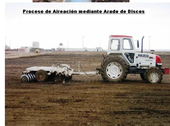
Homogenización y Aireación de suelo contaminado en un lote.
